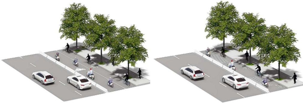
Hình 37. Mô hình thiết kế làn xe đạp đi chung với làn xe cơ giới (Nguồn: WRI, năm 2021)
